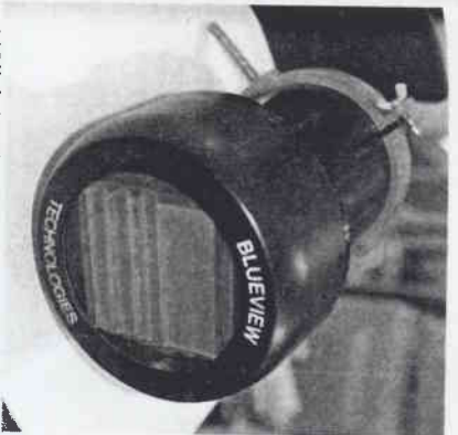
高分解能水中画像が得られる音響カメラ
